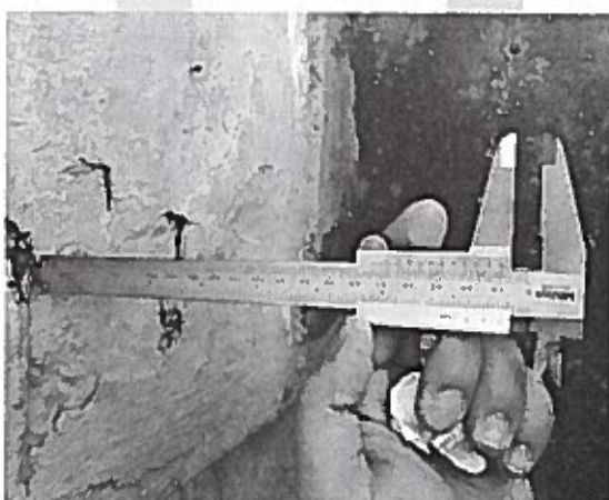
Foto 27 – Pilar 9 – Cobrimento 7mm
